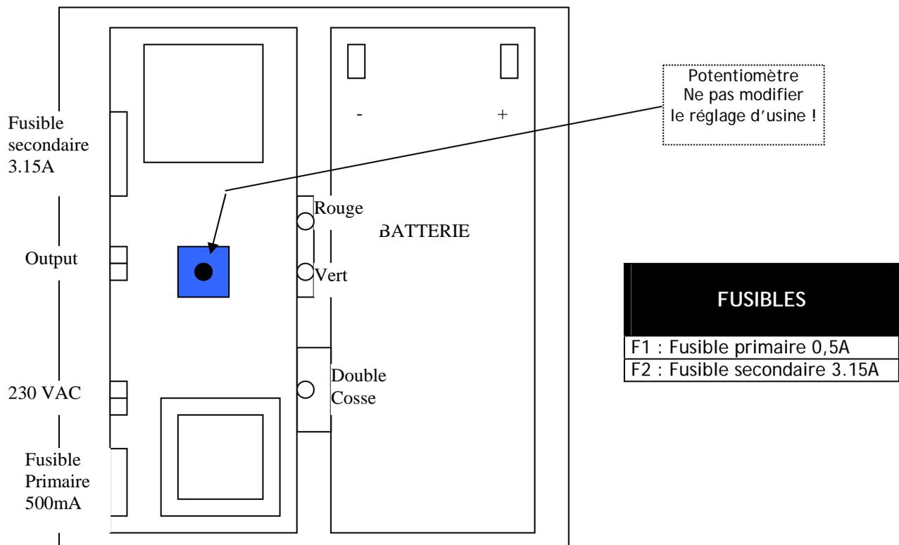
Au remontage ne pas oublier de rebrancher les fils de la batterie !
